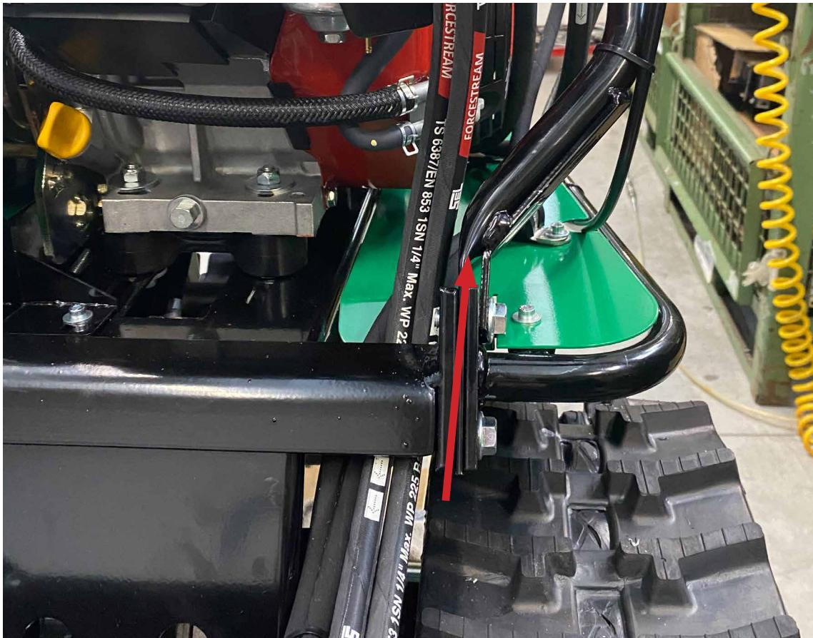
**Posizionamento tubi idraulici kit pala neve - 2**
