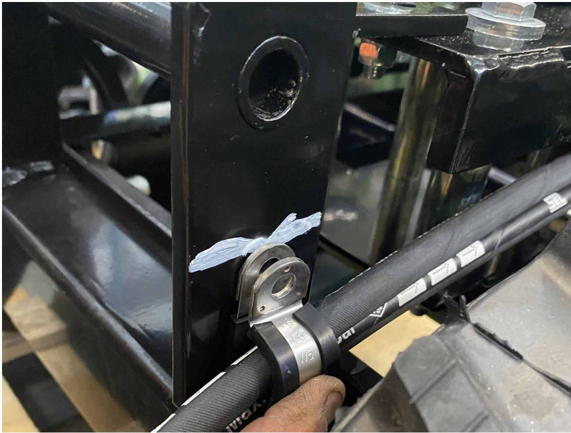
**Opzione 1: forare e filettare la piastra sotto la linea precedentemente tracciata. Avvitare la fascetta in dotazione per fissare i tubi del kit pala neve (utilizzare la vite in dotazione).**
