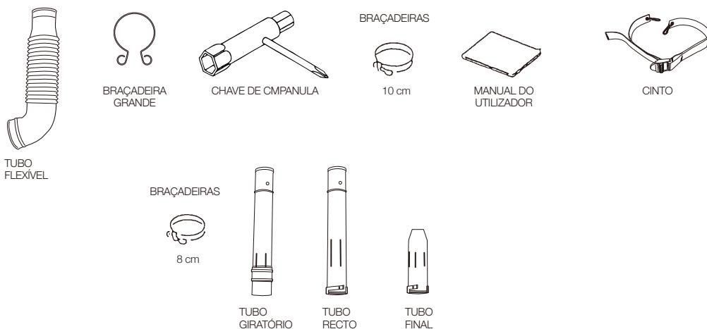
PASSO 2) Utilizando as BRAÇADEIRAS, ligue o TUBO FLEXÍVEL ao soprador e o TUBO GIRATÓRIO ao tubo flexível (ver desenho).
