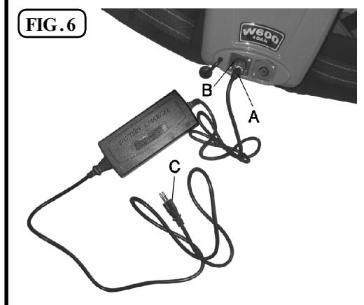
**CONNECTING THE BATTERY CHARGER AND THE CHARGING LEVEL Fig. 6**
